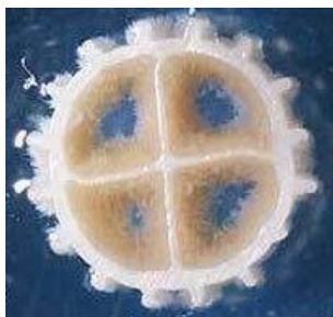
Figur 1 - Biobärare med påväxt av biohud
